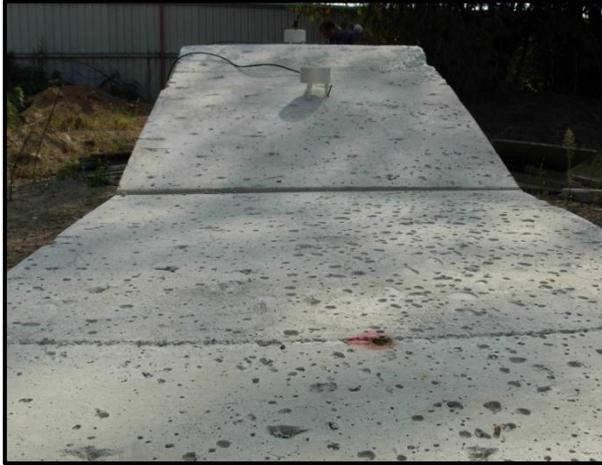
爆破振動監測設備(a)
